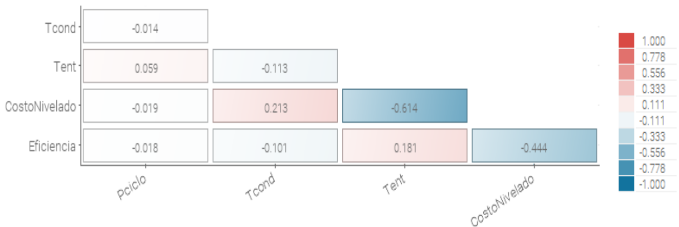
Figura 32. Correlación de Pearson para cada una de las variables de diseño del ciclo, la eficiencia y costo nivelado del ciclo en función de todos los fluidos seleccionados.
