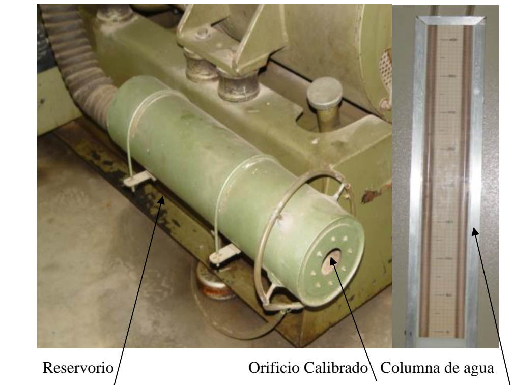
Figura 23. Sistema de medición del flujo másico de aire en el motor
