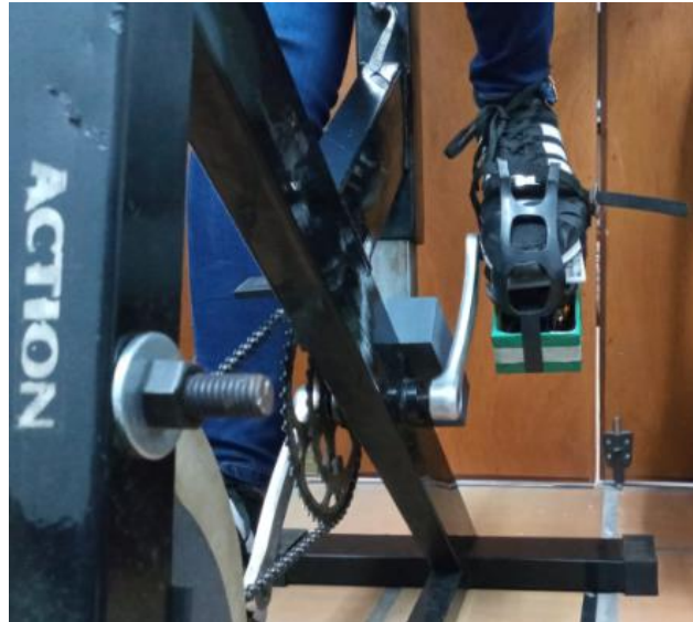
Figura 50. Celda de carga ubicada en puntera [Autores]
