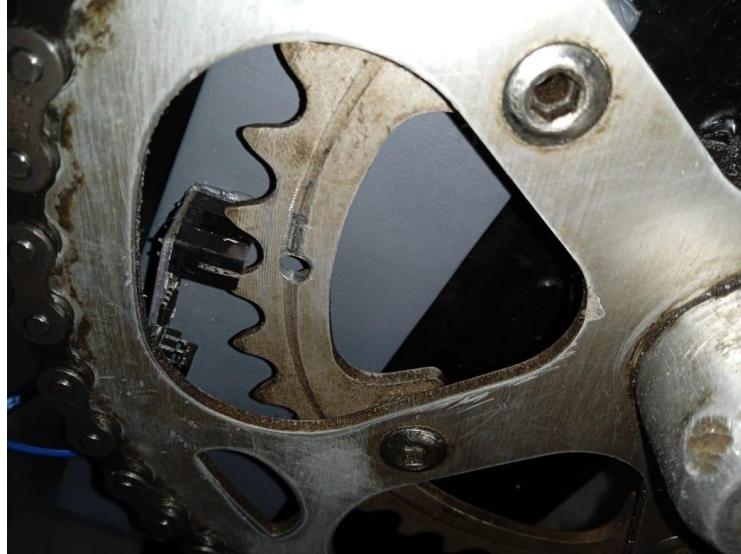
Figura 45. Sensor de velocidad FC-03 ubicado en bicicleta [Autores]
