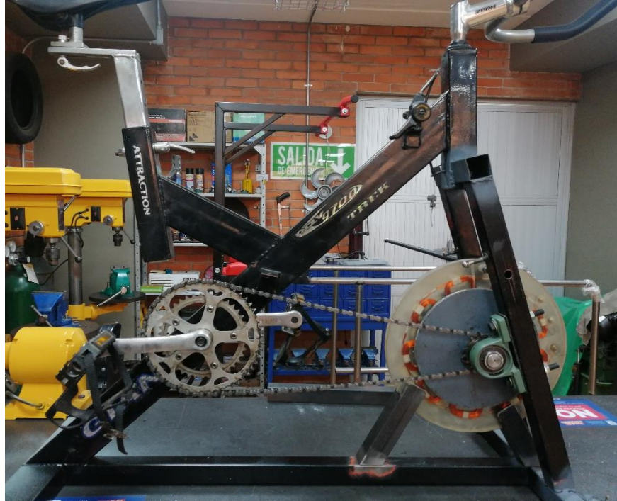
Figura 40. Prototipo ensamblado (mecanismo-generator) [Autores]
