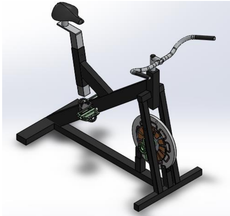
Figura 18. Generador integrado a bicicleta [Autores]
